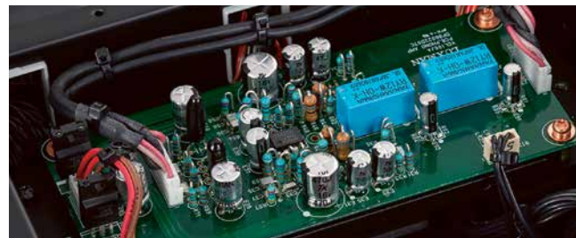
Der gegenüber Einstrahlungen anfällige Phono-Trakt sitzt normalerweise unter einer abschirmenden Metallhaube. Lohn der Mühe: selbst mit MCs nur geringes Rauschen und kein Brummen.
