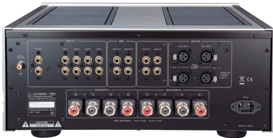
▲ Der Luxman besitzt eine gute klassische Ausstattung: Phono-MM/MC, sechs Hochpegeleingänge, davon zwei symmetrisch und mit umschaltbarer Pinbelegung (Phase) und ordentliche Lautsprecheranschlüsse für zwei Paare oder Bi-Wiring. Die Verstärkerzüge sind auftrennbar.
